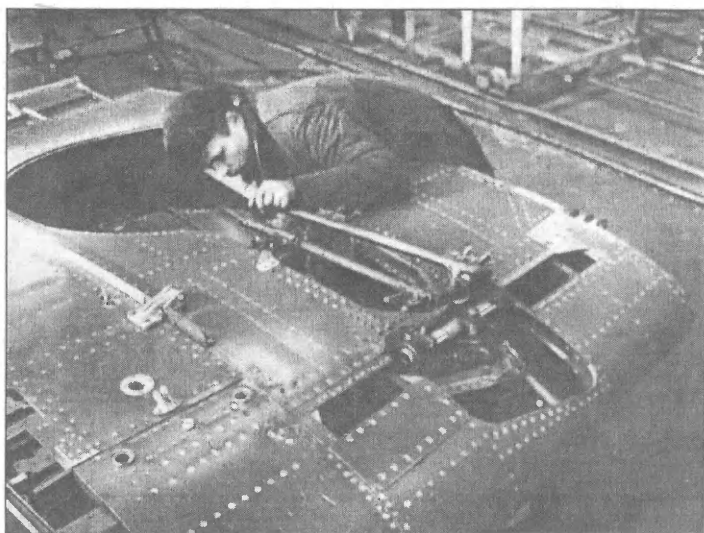
Сборка носовой части крыла. 1944 год. Завод № 1
